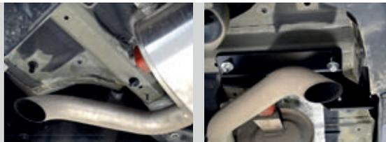
**ШАГ 4.** Для установки центрального кронштейна совместите отверстия в центральной балке с отверстиями кронштейнов и соедините всё болтами M10x40x1,25 через шайбы M10, гайками M10x1,25.
