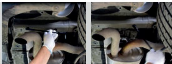
**ШАГ 2.** Выпрямите закладную, держа её за шпильку. Совместите отверстия в закладной и в лонжероне. Совместите кронштейн боковой с отверстиями в лонжероне и закрепите кронштейн болтом M10x40x1,25. через шайбу M10 и гроверную шайбу M10. А так же гайкой M10 с шайбой M10 и гроверной шайбой M10.
