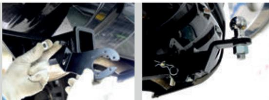
Тип шара «Е»; Тип соединения: шаровый; Диаметр сцепного шара: 50 мм.; Масса комплекта ТСУ 17031501: 19,7 кг.
