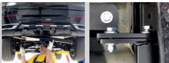
**ШАГ 5.** Затяните все резьбовые соединения. Закрепите кронштейн розетки гайкой M10 через шайбу и гровер M10. Установите съемный шар в сборе и закрепите его пальцем гнутым с шплинтом. Зафиксируйте съемный шар винтом M10x20 снизу. Затяните шар с помощью ключа рожкового или головки на 38мм. Установка завершена.
