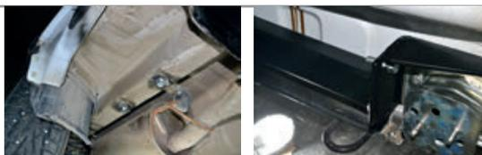
**ШАГ 3.** Установите опоры усилителя заднего бампера с помощью болтов M8x40, через шайбы 8 гроверные и шайбы 8.
