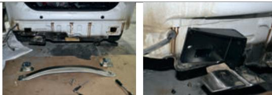
**ШАГ 2.** Закрепите кронштейны в нижней части лонжеронов болтами M10x1,25x40 через шайбы 10 увеличенные и гроверы 10.
