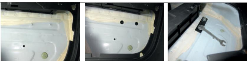
**ШАГ 4.** Установите левый кронштейн, прикрутив его к болтам с помощью гаек M12 через шайбы 12 и гроверы 12. Прикрутите правый кронштейн с помощью болтов M12x45 к штатным закладным гайкам в правом лонжероне. Установите балку ТСУ и прикрутите её болтами M10 и гайками M10.
