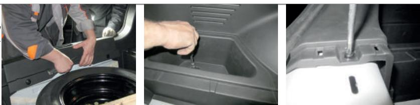
**ШАГ 2.** Крестовой отверткой открутите 4 винта крепления левой ниши к обивке, снимите корытце ниши. Вставьте круглое долото или толстое шило в малые отверстия в нижней части левого заднего лонжерона и с помощью ударов молотком по долоту наметьте два отверстия.
