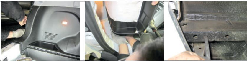
**ШАГ 3.** Из багажника установите пластины (поз. К), совместив её с метками и убедитесь, что метки совпадают с центрами отверстий в пластине. Просверлите два отверстия согласно меткам. Установите пластины и вставьте в отверстия болты M12x130 с надетыми на них втулками и шайбами.
