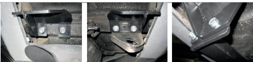
**ШАГ 5.** Установите кронштейн розетки и закрепите его с помощью гаек M10, шайбы 10 и шайбы 10 гроверной. Затяните все соединения, отрегулировав положение ТСУ. Установите съёмный шар в сборе и закрепите его пальцем гнутым гальванизированным со шплинтом пружинным игольчатым. Установите обивки на место.
