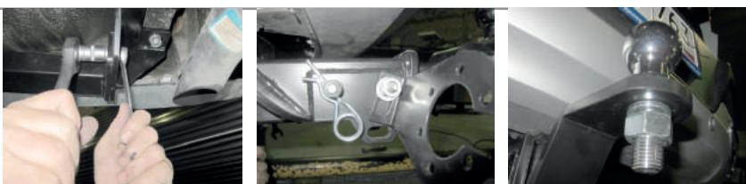
**ШАГ 6.** Затяните шар ключом на 38 мм. Установите фиксирующий болт M10x20 снизу, он используется для исключения технологических люфтов съемного шара и только в ненагруженном состоянии! Перед сцепкой болт демонтировать!
