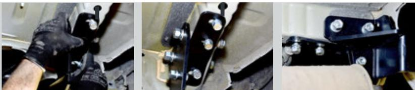
**ШАГ 4.** Для установки фаркопа совместите отверстия в сварном кронштейне с резьбовыми отверстиями кронштейнов и соедините всё с помощью болтов М10х40х1,25, через шайбы М10, шайбы пружинные М10 и гайки М10х1,25. Затяните все резьбовые соединения.
