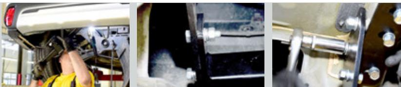
**ШАГ 5.** Установите усилитель и глушитель на место. Установите запасное колесо на место. Установите съемный шар в сборе и закрепите его пальцем гнутым со шплинтом. Зафиксируйте съемный шар болтом М10х20. Установка завершена.
