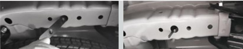
**ШАГ 2(2)** Установите кронштейн боковой с внутренней стороны лонжерона, гибом к центру авто и прикрутите его с помощью болтов М12х110х1,25 продетых сквозь лонжерон, гайками М12х1,25, через шайбы М12 и шайбы пружинные М12.
