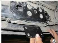
**ШАГ 3.** Установите сварной кронштейн ТСУ вместе с центральной закладной (поз. О), совместив отверстия кронштейна с отверстиями в балке заднего бампера и закрепите всё с помощью четырёх болтов М12х120, через пружинные шайбы 12, шайбы 12 с двух сторон, гайками М12 и двух болтов М16х50 (через пружинные шайбы 16) и двух болтов М6х35 снизу кронштейна.
